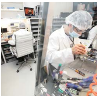
Grefte électromécanique en salle blanche sur un disque dur défectueux.
